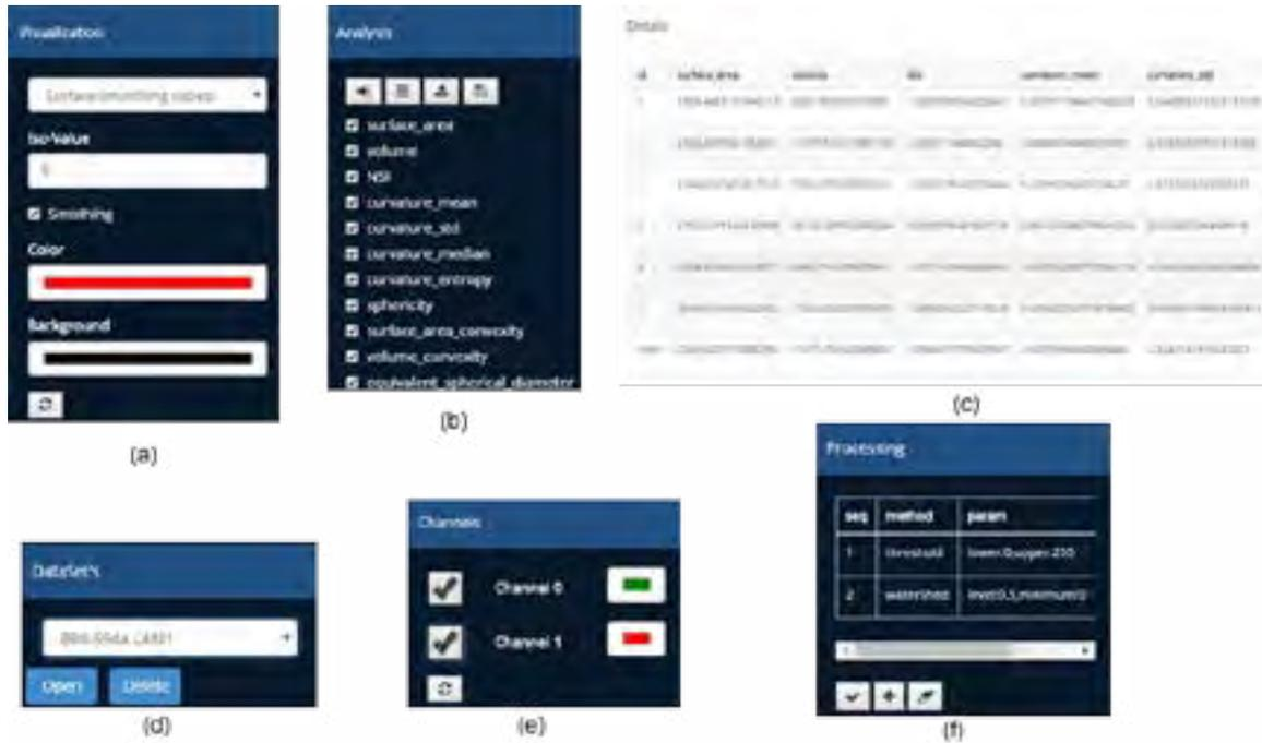
Figura 5: Funcionalidades para ViSC e Citomorfometria. (a) Seleção e configuração dos algoritmos de ViSC. (b) Extração das medidas utilizando métodos de citomorfometria. (c) Medidas extraídas. (d) Seleção do conjunto de dados. (e) Escolha dos canais. (f) Segmentação
