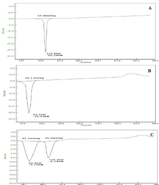
**FIGURE 4** - DSC thermograms of A) FPN B) PEG 10000 C) SD8 formulation.
