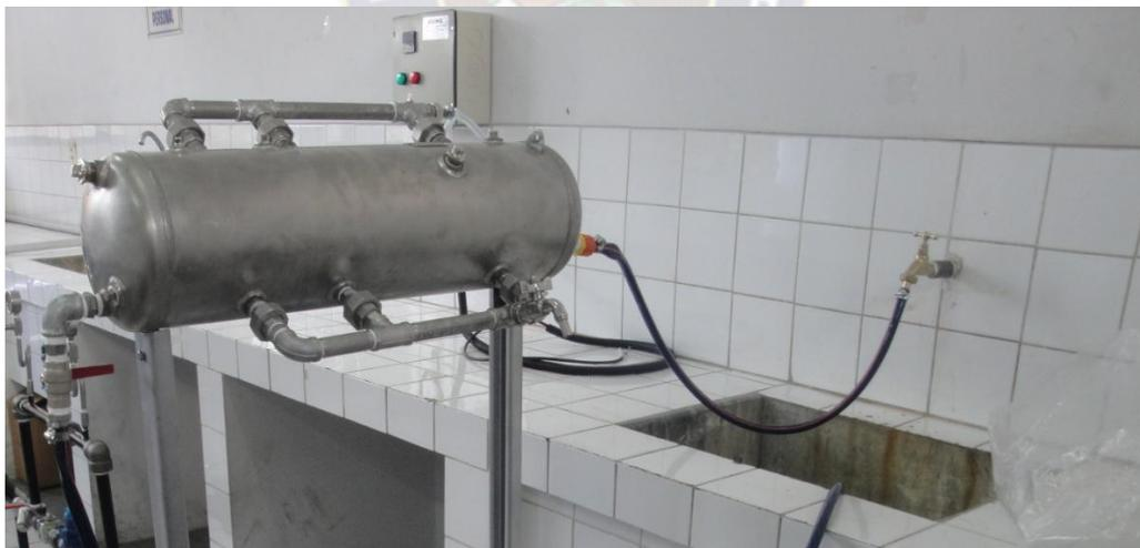
Vista interna del extractor de aceites esenciales y vista externa del condensado
