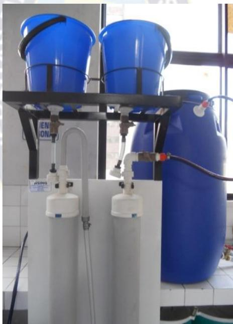
**Figura 21.** Foto del equipo para ablandar agua, en la Carrera de Química Industrial.
