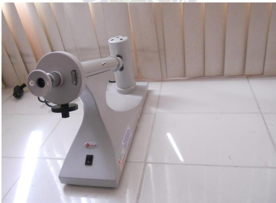
b) Imagen del Polarímetro de disco, que se ha utilizado
