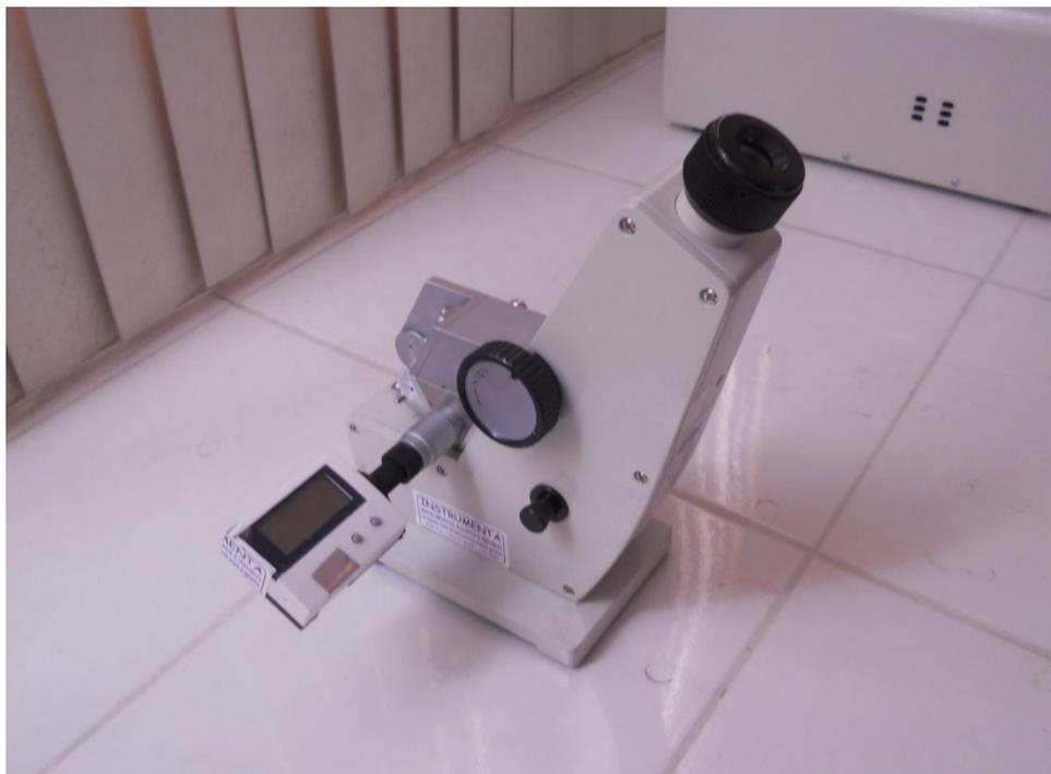
a) Imagen del Refractómetro de mesa, que se ha utilizado
