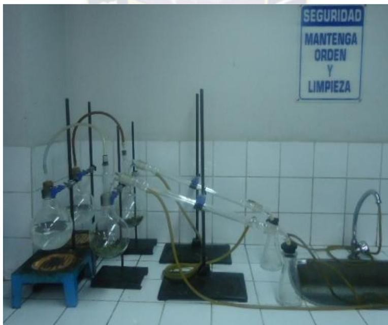
Equipos de destilación por arrastre con vapor de agua a nivel laboratorio
