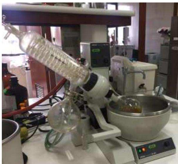
Figura 30. Evaporación de los solventes de cada fracción. Se utilizó diferentes niveles de presión para cada solvente. La temperatura del baño de agua fue 40 °C.
