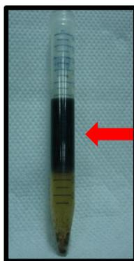
Figura 19. Técnica de colorimetría reactivo de Liebermann-Burchard para detección de terpenoides. Nótese el color verde oscuro en la parte superior del montaje respectivo (Fuente: Autor).
