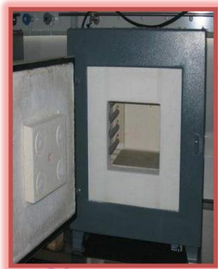
Se incineró en un horno mufla a una temperatura de 700 a 750 °C por 2 h.
