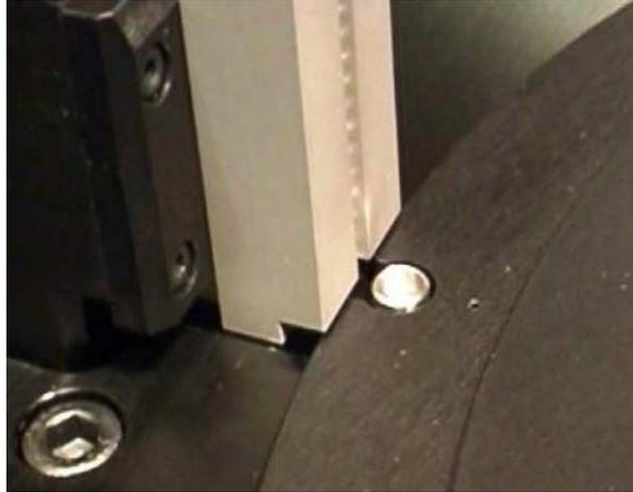
**Figura 2.29**-Copela liberada pelo carregador no disco giratório
