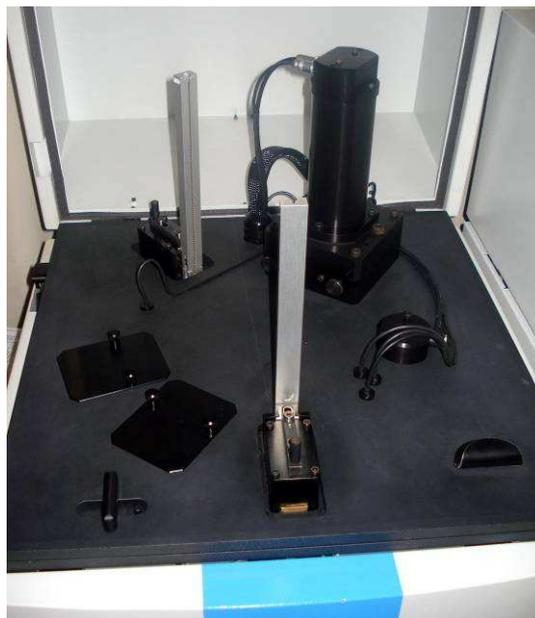
**Figura 2.30**-Visão superior interna da leitora Fimel PCL3 onde aparecem o descarregador (esquerda), o carregador (centro) e a fotomultiplicadora (direita)
