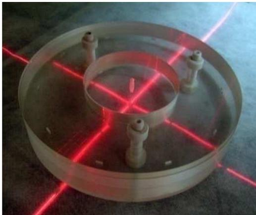
**Figura 3.9**–Fantoma de acrílico construído para dosimetria termoluminescente
