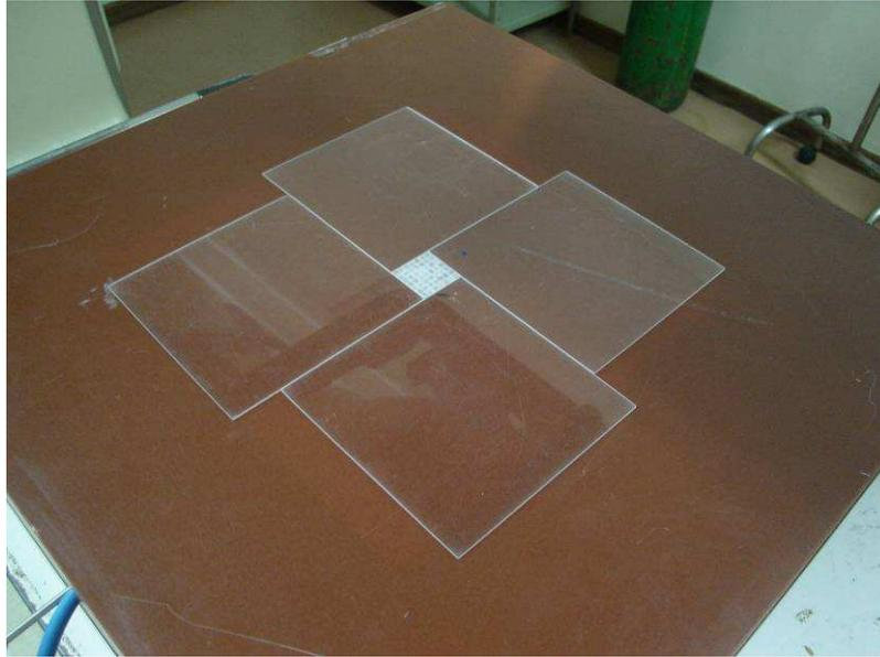
**Figura 2.31** -Arranjo experimental da irradiação dos TLDs para seleção
