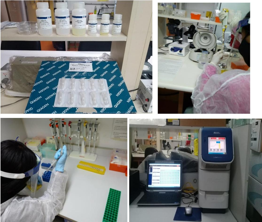
**Figura 2** – Imagens das práticas laboratoriais: 1) e 2) extração de DNA (Kit DNeasy Blood and Tissue Qiagen), 3) Preparação de amostras para PCR, 4) Imagem do equipamento de PCR-RT (StepOne, Applied Biosystem). Autor: Thaysa Carolina Cantanhede Figueiredo.
