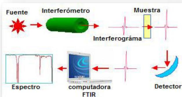
Figura 15. Partes básicas del equipo de IR
