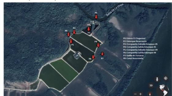
Fig. 1. Puntos de muestreo para el monitoreo de calidad de agua en camaronera Eben Ezer.
