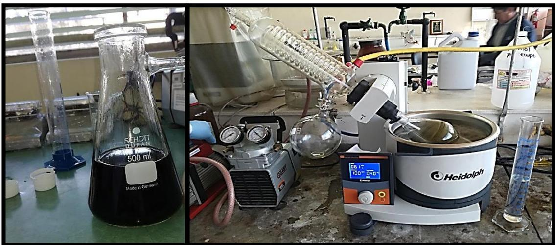
**Figura 11.** Rotavapor- Evaporación del alcohol de las muestras
