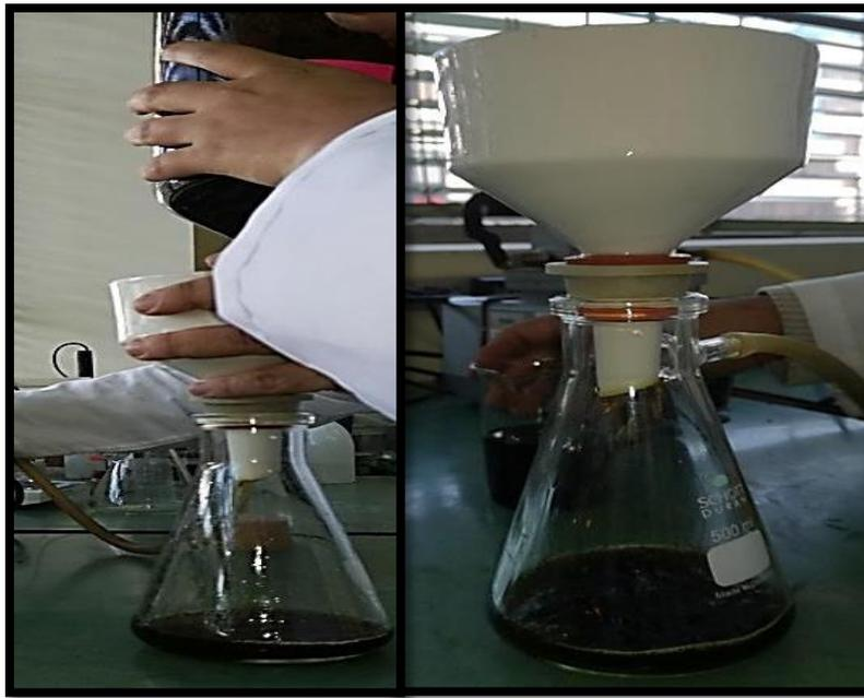
**Figura 10:** Sistema de filtración de las muestras
