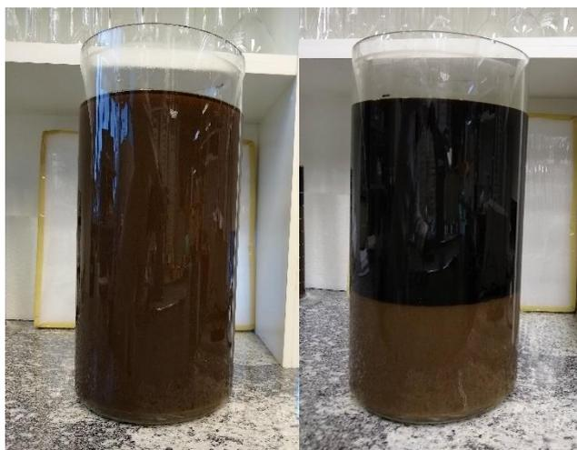
**Figura 9.** Vinhaça *in natura* antes da coagulação-floculação (A) e após precipitação (B).
