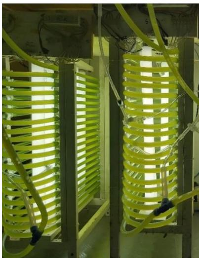
**Figura 8.** Fotobiorreator tubular do tipo *air-lift*.
