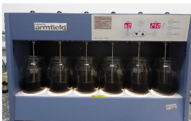
**Figura 6.** Ensaios em *Jar Test*. Fonte: a autora.
