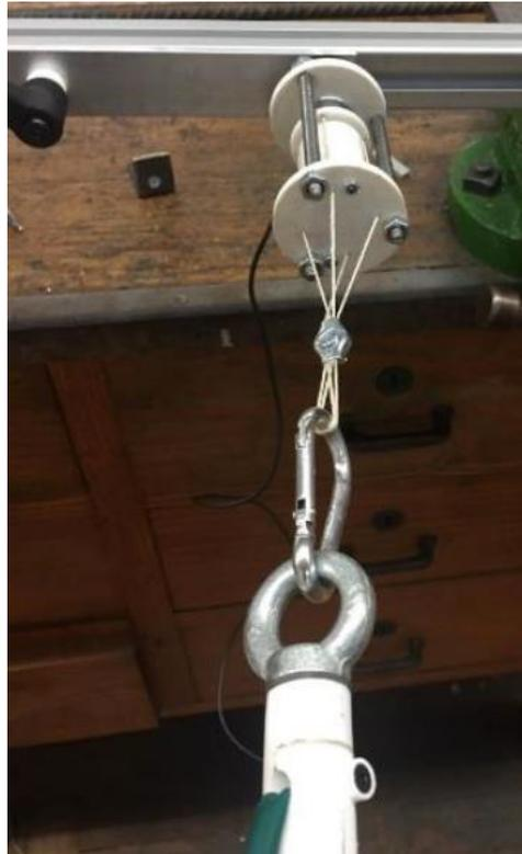
**Figura G.** Célula de carga para quantificação de força exercida
