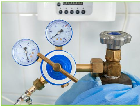
Imagen 6: Regulador de oxígeno para cilindro de gas. La válvula de la botella regula el gas que sale de ésta (manómetro más cercano a la botella) y el regulador controla el gas que entra al circuito (manómetro de la izquierda). En esta imagen se ve como se ha conectado directamente al regulador el tubo de poliamida.
