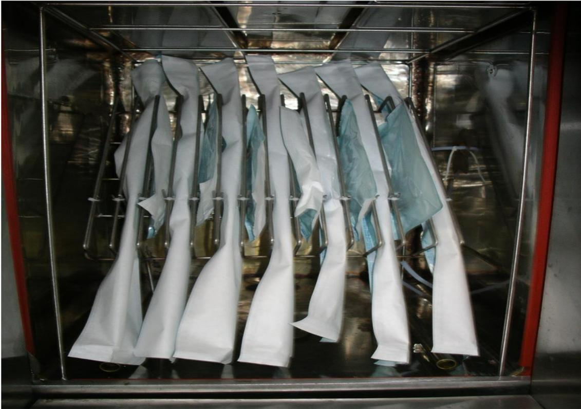
**Figura 17:** Distribuição, intercaladamente, de um mesmo comprimento e diâmetro dos monitores biológicos de canulados de aço inoxidável e silicone, dentro da câmara do esterilizador a base de ozônio.
