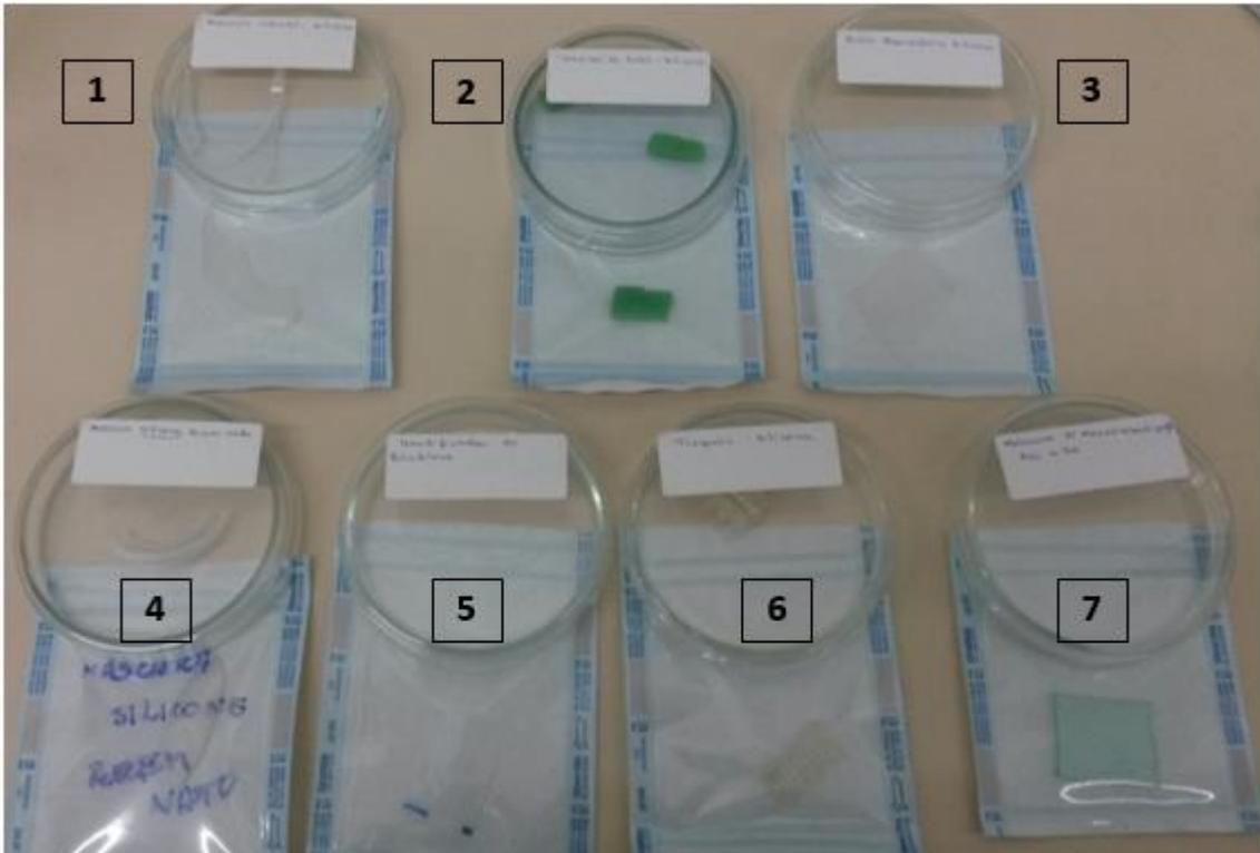
**Figura 19:** Amostras de materiais médico-hospitalares: 1 – máscara infantil (silicone); 2 – conector (silicone); 3 – balão reservatório; 4 – máscara recém nato (silicone); 5 – umidificador (polietileno); 6 – traqueia (silicone) e 7 – máscara para macronebulização (policloreto de vinila).
