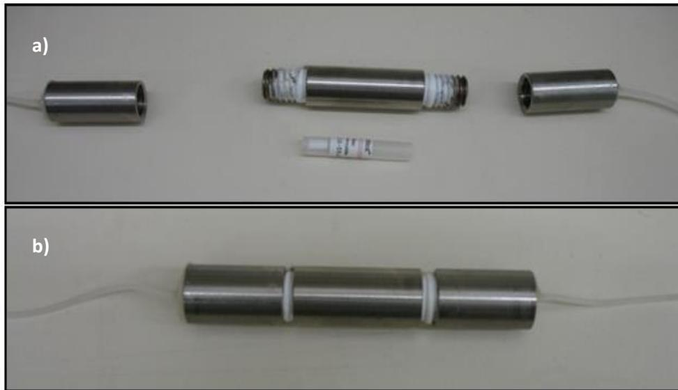
**Figura 14:** IB introduzido no interior do canulado de silicone, representando o monitor biológico.
