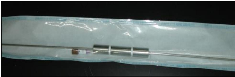
**Figura 15:** Canulado de aço inoxidável, utilizado como monitor biológico, embalado com papel grau cirúrgico juntamente com o IB.
