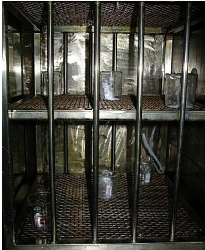
**Figura 20:** Distribuição na câmara do Esterilizador por Ozônio dos frascos contendo endotoxina bacteriana para teste de pirogênio.
