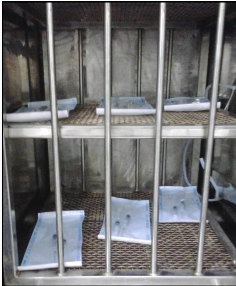
**Figura 10:** Distribuição na câmara do Esterilizador por Ozônio dos desafios com seringas de polipropileno de 3 mL.
