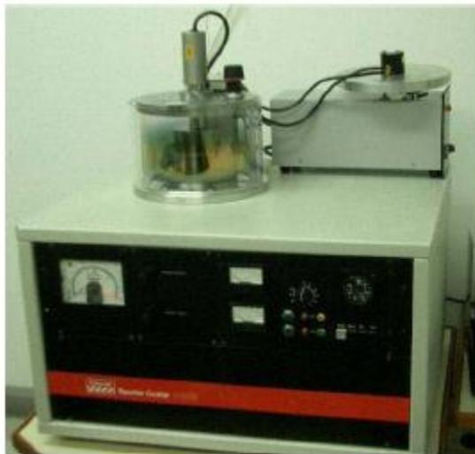
**Figura 22.** Equipamento de deposição de ouro marca Edwards, modelo “*sputter coater 5150B*”.
