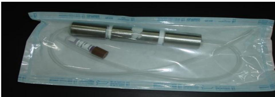
**Figura 16:** Canulado de silicone, utilizado como monitor biológico, embalado com papel grau cirúrgico juntamente com o IB.
