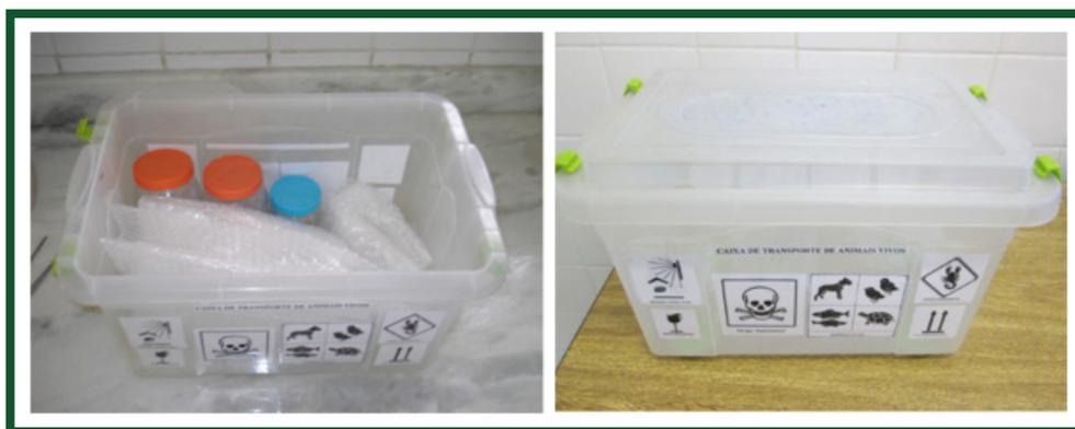
FIGURA 10: CAJA DE TRANSPORTE CON IDENTIFICACIÓN DE RIESGO. FOTO: LABFAUNA.
